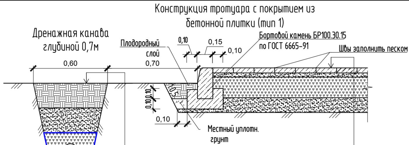
Конструкция тротуара с покрытием из бетонной плитки (тип 1)
