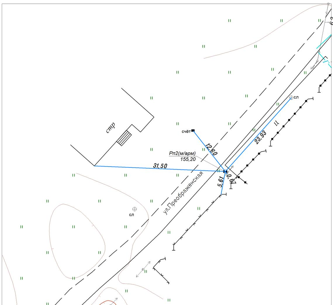
Положение репера на топографическом плане (Абрис)
